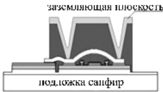
Рис. 1. Поперечное сечение пластины с межэлектрическими соединениями, обеспечивающими общую заземляющую плоскость
