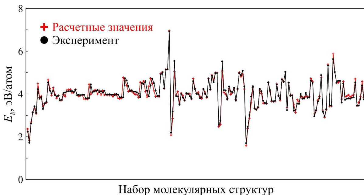
Рис. 1. Сравнение расчетных энергий связи E_b для некоторых молекулярных соединений с экспериментальными данными
