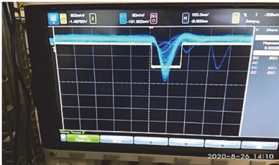
Рис. 4.16. Сигналы с электронного тракта установки, подготовленные для зарядового оцифровщика (аналоговый и цифровой – Gate)
