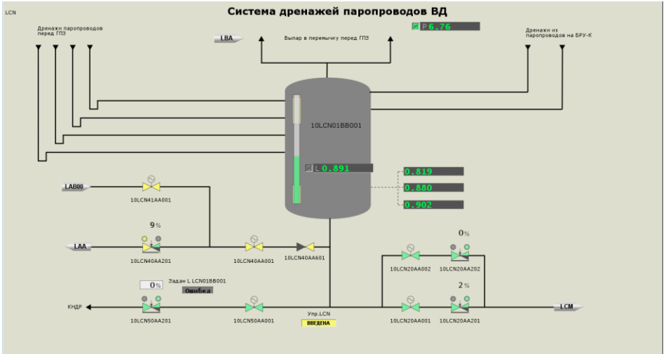
Рисунок 4.5.7 – Видеоквдр системы дренажей паропроводов высокого давления (LCN)
