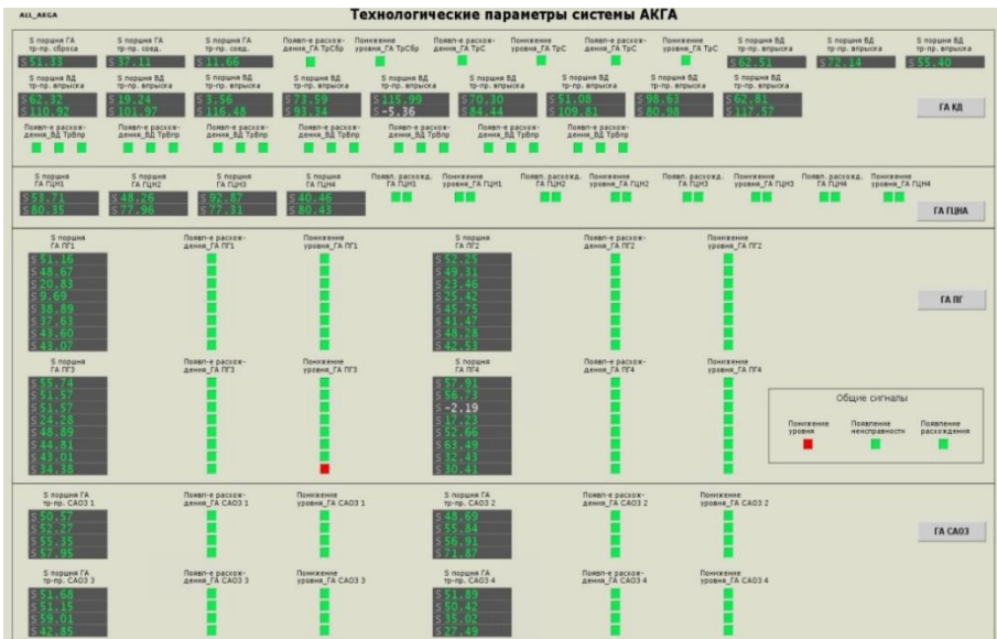
Рисунок 5.2.6 – Видеокадр контроля состояния гидроамортизаторов
