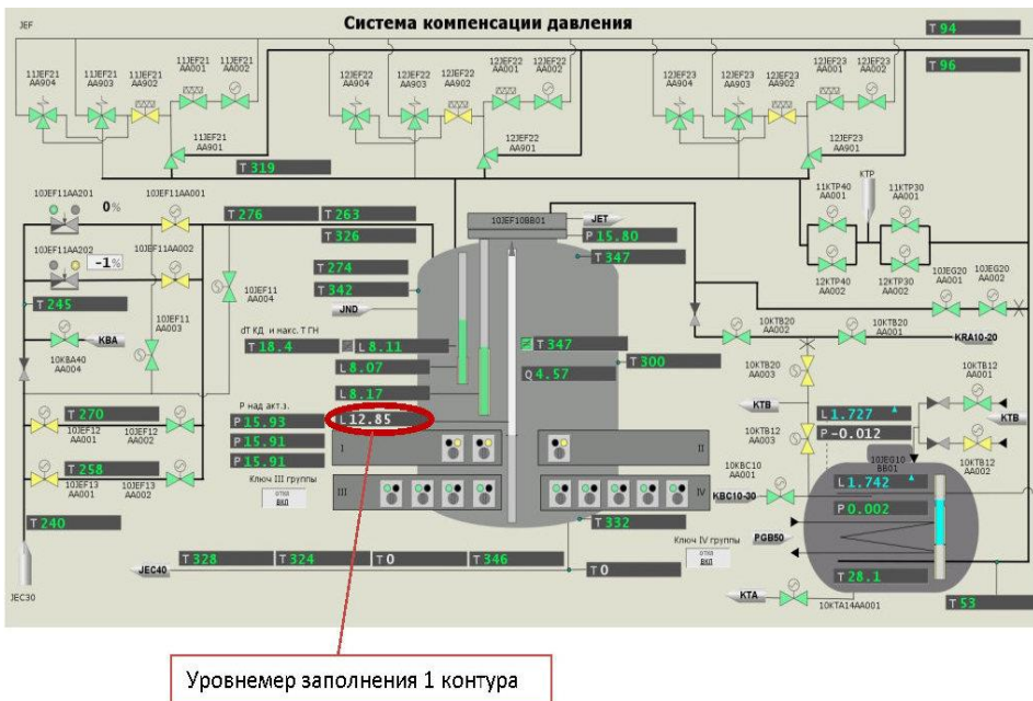
Рисунок 4.1.3 – Видеокادر системы компенсации давления с уровнемером заполнения 1го контура
