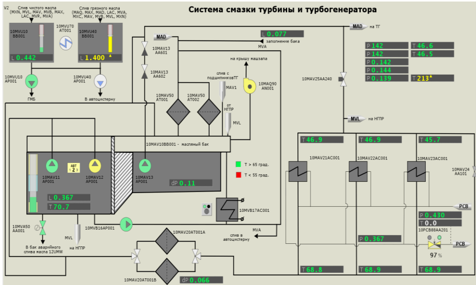
Рисунок 4.5.12 – Видеокادر системы смазки подшипников турбины и турбогенератора (MAV)
