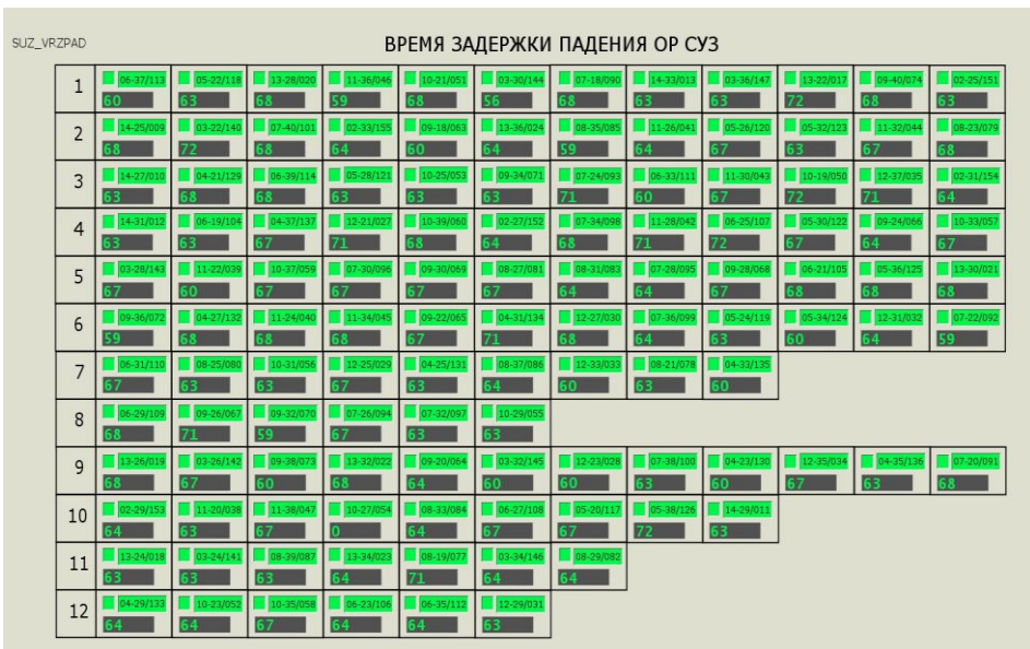
Рисунок 6.2.2 – Видеокадр времени задержки падения ОР СУЗ
