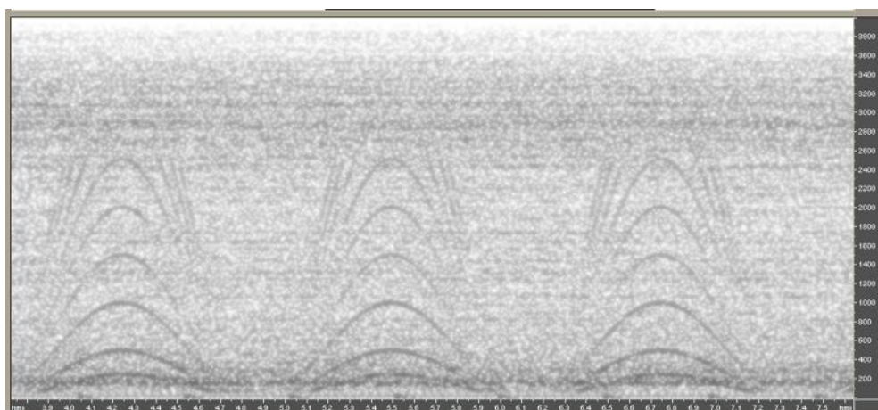
Рис. 9. Спектрограмма смеси ТС-«белый шум» SNR=-12 Дб, снятая в одной из точек помещения конфиденциальных переговоров
