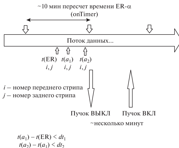
Рис. 5. Схематичное представление гибкого алгоритма при поиске ER-α корреляций.
