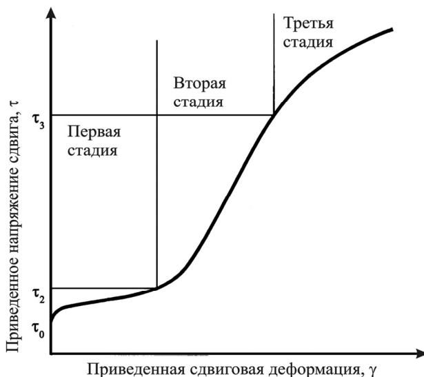
Рис. 4.20. Типичная кривая напряжение – деформация кристалла чистого металла с ГЦК решеткой
