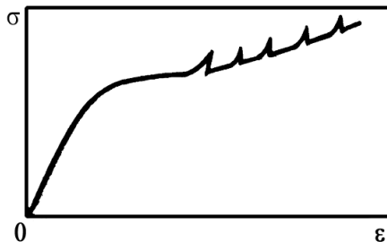
Рис. 4.30. Эффект Портевена–Ле Шателье, обнаруживаемый, например, при растяжении поликристаллических алюминиевых сплавов
