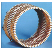
Рис. 32. Сегмент статорной катушки, намотанной из семижильного MgB_2 провода ( J = 310\,000\text{ A/cm}^2 at 20 K)
