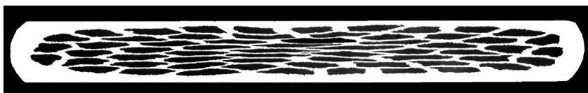
Рис. 9. Поперечное сечение 61-жильного проводника перед термообработкой
