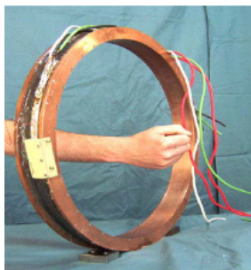
Рис. 30. Изготовленная компанией Hyper Tech испытательная катушка (482 витка) для ЯМР томографии:
