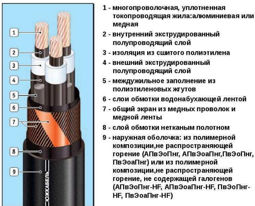
Рис. 5.14 – Строение кабеля.
