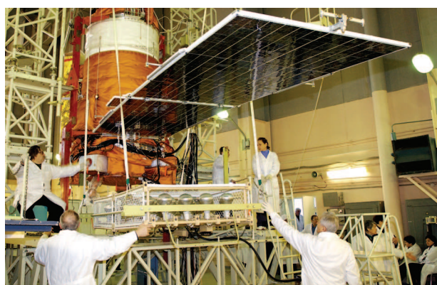
Проверка работоспособности солнечных батарей спутника в монтажно-испытательном комплексе космодрома «Плесецк».
