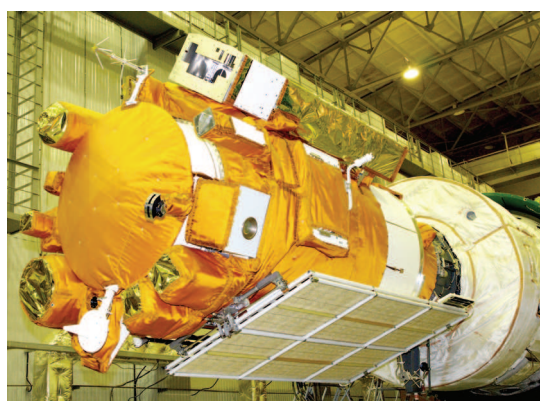
Общий вид космического аппарата «КОРОНАС-ФОТОН» со стороны приборной платформы (солнечные батареи сложены).
