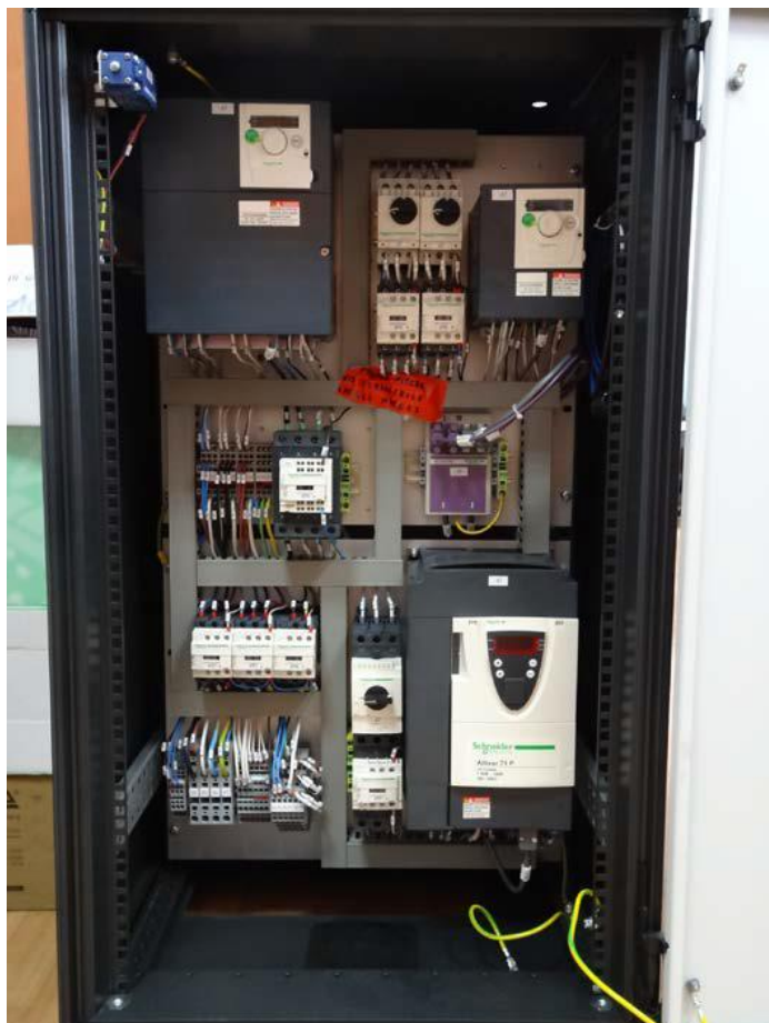
Рисунок 17 – Компоновка бортовой системы управления роботом-штабелером в шкафу управления
