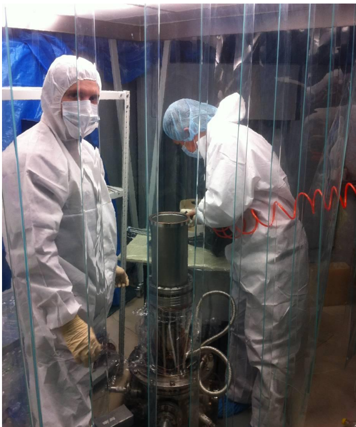
Рис. 2.11. Сборка детектора РЭД-1 на экспериментальной площадке ГЭК-10 в переносной чистой комнате
