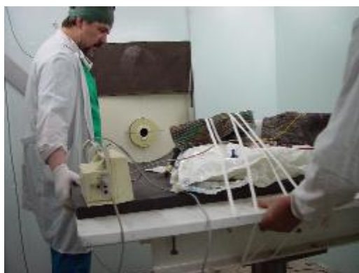
Рис. 3.17. Устройство вывода пучка нейтронов в облучательном боксе и стол для крепления животного (а); размещение собаки в боксе перед облучением (б)
