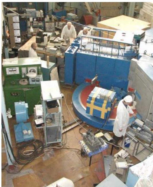
Рис. 2.1. Общий вид и схема дифрактометра с суперпозиционной многодетекторной системой регистрации тепловых нейтронов: 1 – коллиматор в секциях шибера; 2 – кристалл-монохроматор; 3 — второй коллиматор; 4 – мониторный счетчик нейтронов; 5 – исследуемый образец; 6 – блок третьих коллиматоров; 7 – блок нейтронных счетчиков
