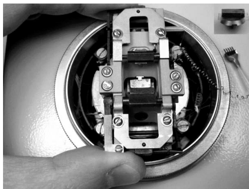
Рис. 13. Осторожное опускание АСМ-столика с кантилевером на образец с контролем зазора (около 0,3–0,5 мм); вид крепления достаточно толстого образца (без промежуточных шайб – вверху справа)
