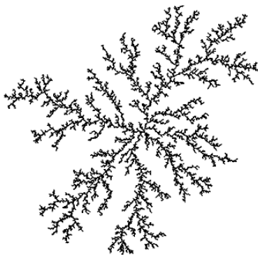
Рис. 14.18. Фрактальный кластер, полученный в процессе диффузионно-ограниченной агрегации
