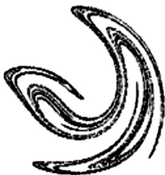
Рис. 14.20. Аттрактор Уеды для уравнения: \ddot{x} + 0,05\dot{x} + x^3 = 2,5 \cos 0,7t
