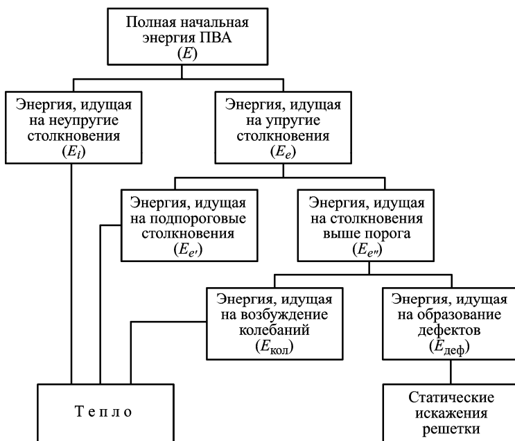
Рис. 12.34. Схема баланса энергии в каскаде атомных столкновений
