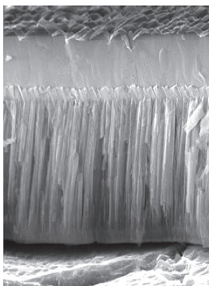
Рис. 14. Схема метода IBAD – ion-beam assisted deposition ( a ); выросшие на подложке кристаллы MgO ( б ), виден небольшой угол (около 15 °) между ними и подложкой
