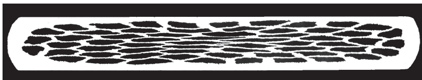
Рис. 9. Поперечное сечение 61-жильного проводника перед термообработкой
