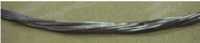
Рис. 44. Двухметровый кабель, скрученный из девяти проводов, (шаг скрутки 5 см)
