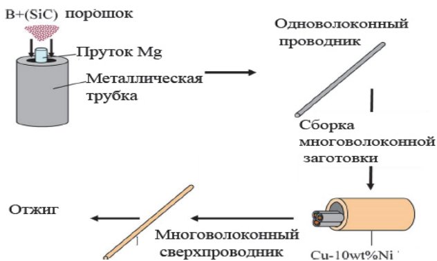
Рис. 31. Технологическая схема получения проводников на основе диборида магния методом «порошок в трубе», вариант IMD
