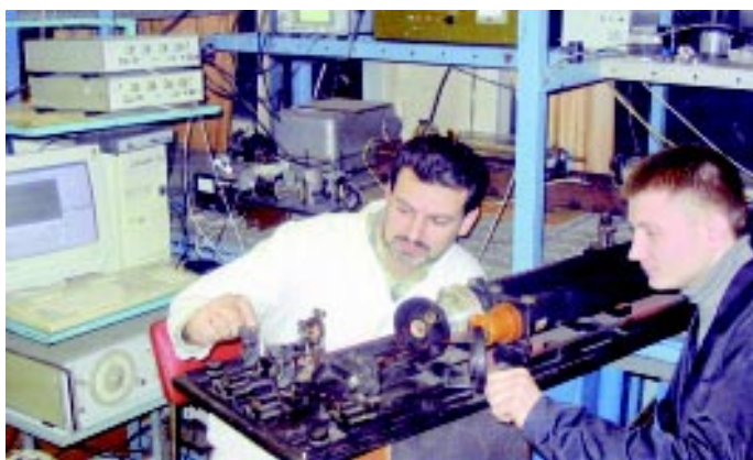
Доцент кафедры лазерной физики А.П. Кузнецов и студент-дипломник К.Е. Коротков за юстировкой лазерного квадратного интерферометра — перспективного прибора для различных областей физики.
