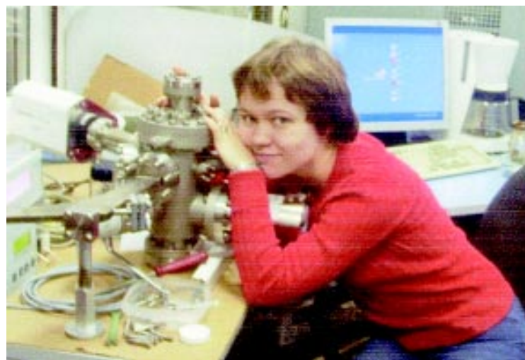
На кафедре физики плазмы Аней Голубевой разработана и защищена сверхвысоковакуумная установка для исследования взаимодействия ионов с твердым телом и атомного инжиниринга поверхности.
