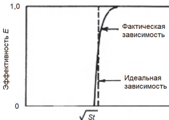
Рис. 14. Идеальная и реальная эффективности осаждения аэрозолей в каскаде импактора в зависимости от числа Стокса
