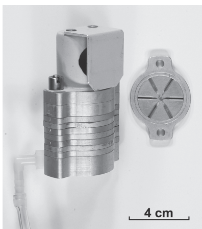
Рис. 17. Восьмикаскадный персональный импактор Marple (Andersen Inc). 2 Объемная скорость воздуха 2 л/мин. Анализ размеров от 0,5 мкм
