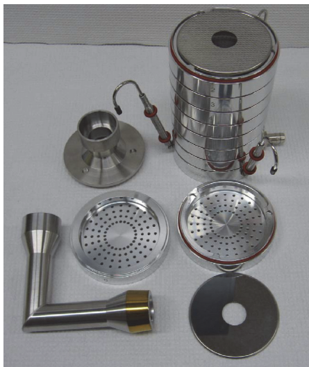
Рис. 16. Восьмикаскадный импактор Андерсена Mark II (ACI). 1 Объемная скорость воздуха 28,3 л/мин. Диапазон размеров 0,3–12 мкм
