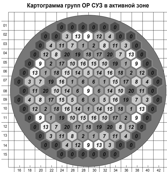
Рис. 2.16. Картограмма условного расположения 121 органа СУЗ по группам в активной зоне ВВЭР-1000 повышенной безопасности
