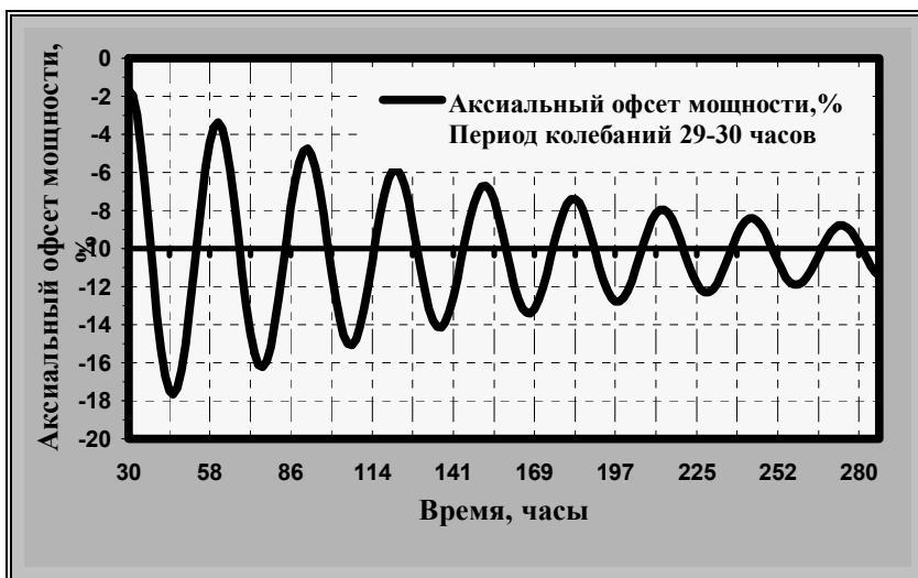
Рис. 1.32. Зависимость аксиального оффета мощности от времени при возбуждении ксеноновых колебаний для 17-й загрузки 2-го блока Калининской АЭС в конце кампании
