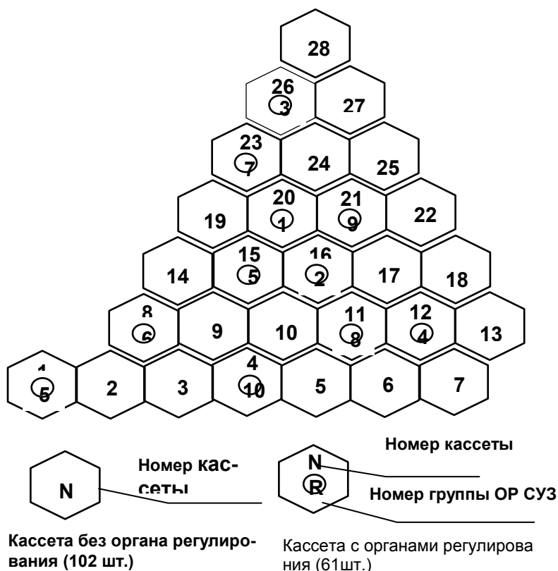
Рис. 3.4. Картограмма расположения органов СУЗ в секторе симметрии 60^\circ активной зоны в 3-го энергоблока Калининской АЭС
