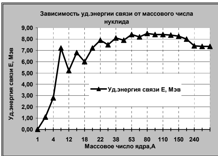
Рис.1.2. Зависимость удельной энергии связи от массового числа нуклида
