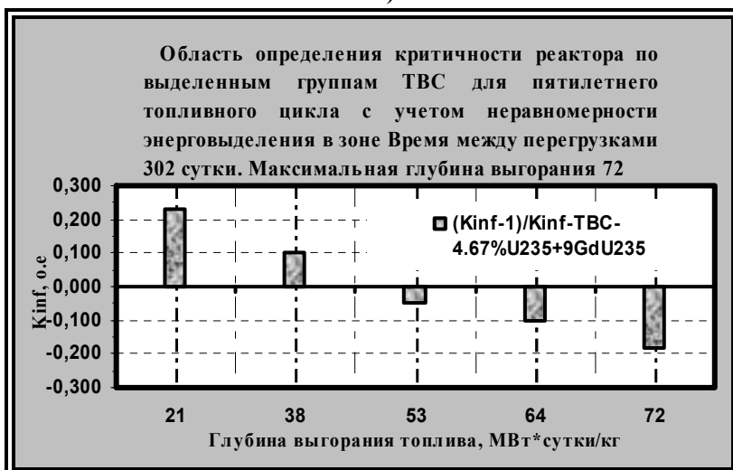
Рис. 1.19. Сопоставление глубины выгорания топлива, выгружаемого из активной зоны ВВЭР-1000 при использовании ТВС с обогащением 4.67%, и траектории размножающих свойств ТВС при перегрузках для случаев учета неравномерности мощности в ТВС и без его учета: А – отсутствие учета неравномерности мощности в ТВС; В – с учетом неравномерности мощности в ТВС при схеме перегрузок по принципу IN-IN.....OUT
