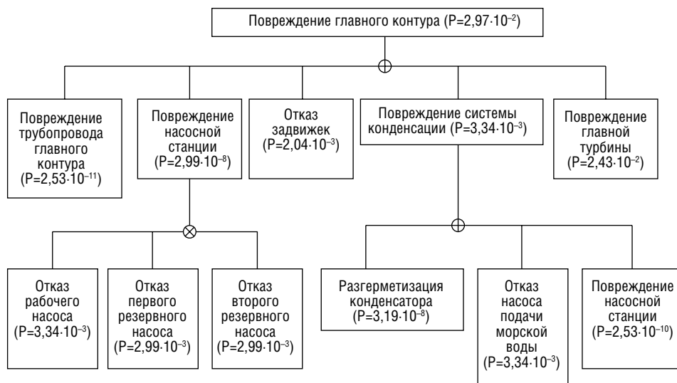
Рис. 4.8. Дерево отказов главного циркуляционного контура РУ 1-го блока АЭС «Фукусима»
