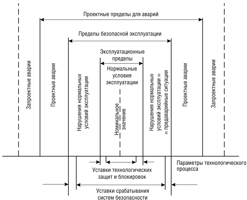
Рис. 1.3. Состояния и проектные пределы АЭС
