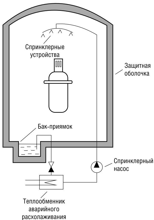
Рис. 3.22. Локализирующая система безопасности АЭС с ВВЭР-1000 (В-320).
