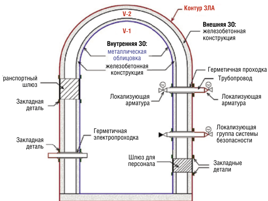
Рис. 3.24. Принципиальная схема ЗЛА ЛАЭС-2. Проект В-491 (ЛАЭС-2)
