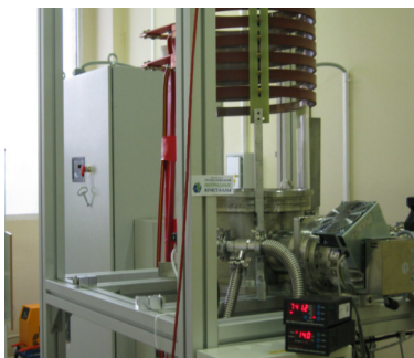
Рис. 1. Установка с индукционным нагревом для сублимационного роста SiC диаметром до 4''
