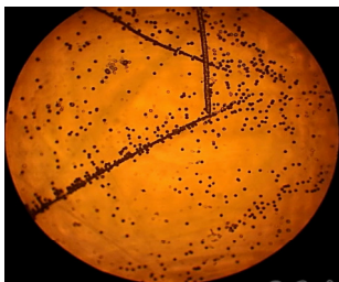
Рис. 3. Распределение плотности дислокаций по поверхности подложки. Оптическая фотография после 20 мин. Травления в КОН
