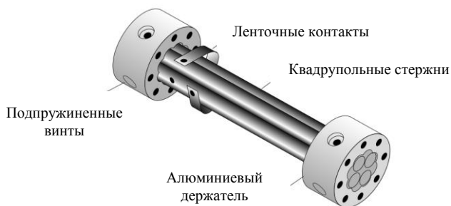
Рис. 5.25. Компоненты квадрупольного фильтра масс
