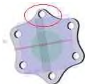
Рис. 1. «Фланец» построенный массивом
