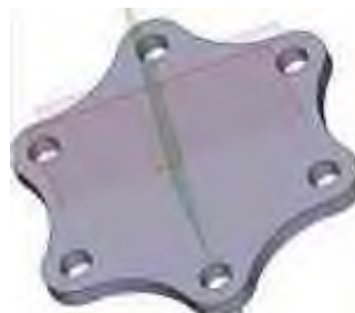
Рис. 2. «Фланец» построенный методом параметризации
