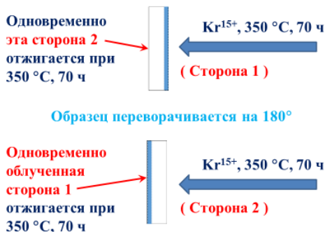
Рис. 1. Схема облучения и отжига образца стали 16X12ВФТАР в двух экспериментах.
