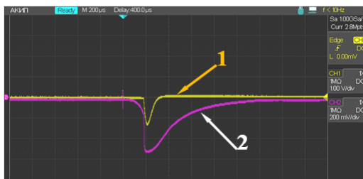
Рисунок 1. Динамика изменения тока (1) и интенсивности теплового излучения (2) обрабатываемого материала.
