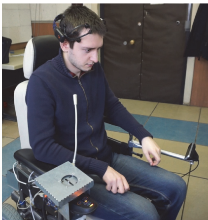
Пример управления роботизированным инвалидным креслом с помощью жестов и ВСИ-интерфейса
