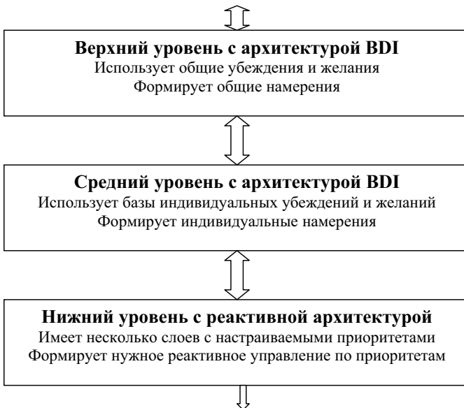
Рис. 8. Когнитивный агент гибридной архитектуры
