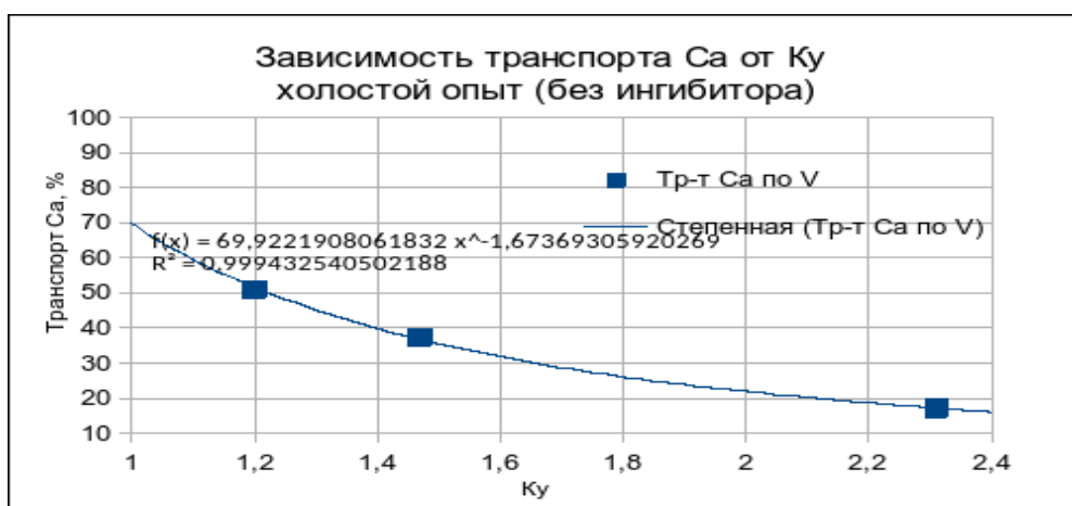
Рисунок 1 – Зависимость транспорта кальция от коэффициента упаривания охлаждающей воды в отсутствие ингибитора в холостом опыте на модельной установке
