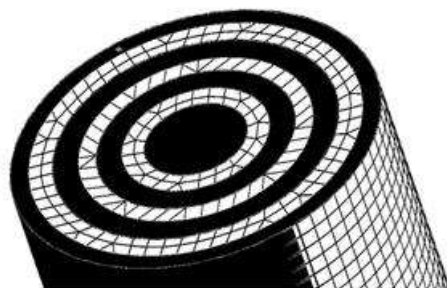
Рисунок 2 - группы полых цилиндров – заменителей спиральных теплообменных трубок в составе расчётной модели
