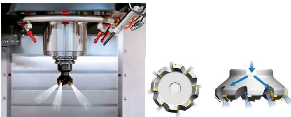
Рисунок 1 – Подача СОЖ через инструмент
