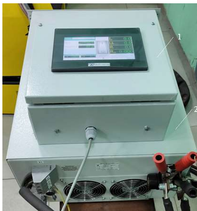
Рисунок 8 – Инверторный источник питания ИОН 48-900, 1 – дистанционный пульт; 2 – силовой блок.
