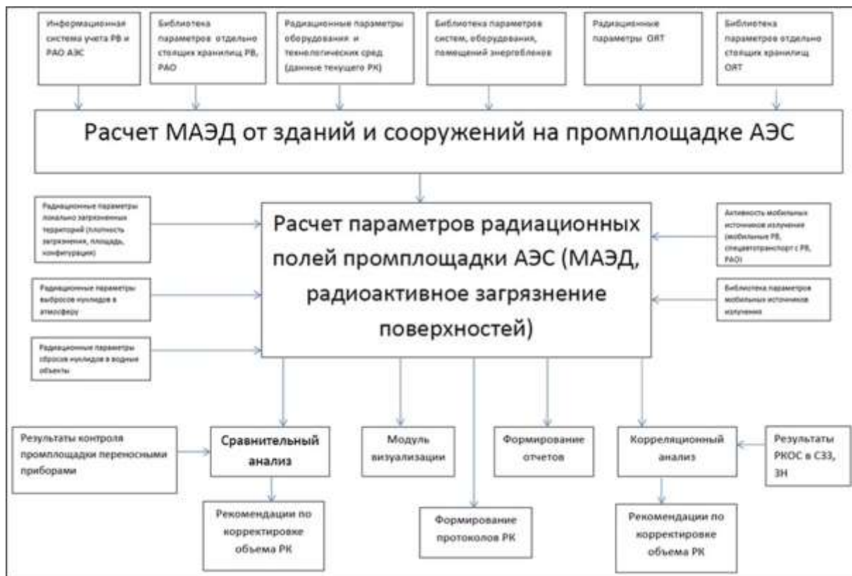
Рисунок 1 – Структура ИАС РКМ АЭС
