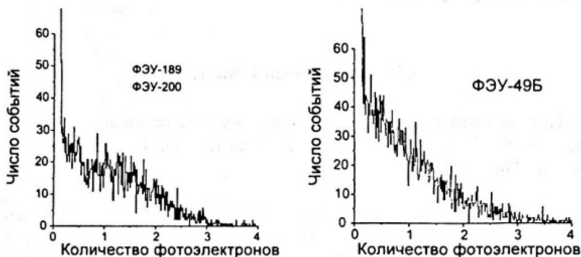
Рис. 5. Распределения зарядов на выходе ФЭУ при одноэлектронной подсветке
