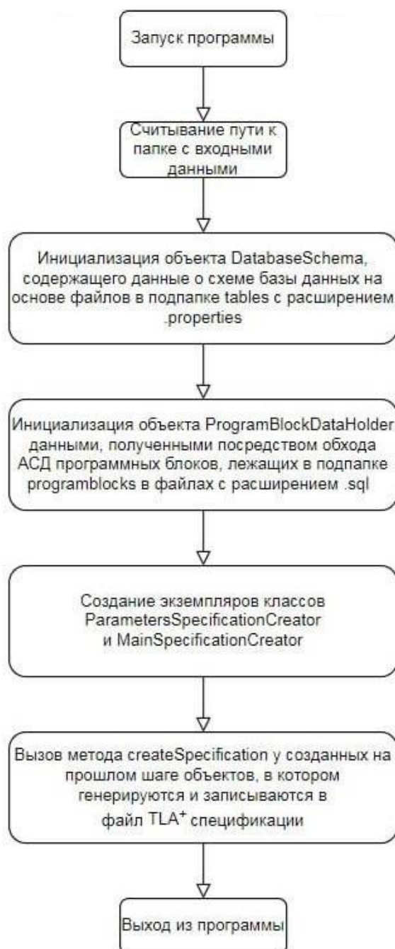
Рис. 2. Схема алгоритма программы plsql2tla Fig. 2. Diagram of the algorithm of the plsql2tla program
