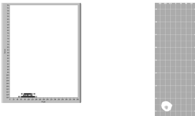
Рис. 2. Выходные данные систем детектирования квенча T-Mapping (слева) и Second Sound (справа)
