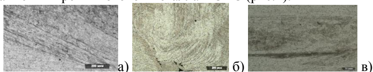
Рис. 2. Поперечный микрошлиф шва алюминиевого сплава АД1 при СТП: а) - ламинарный поток со стороны заплечика; б) - турбулентный поток со стороны нижней части пина, с ламелями разделенными на микрзерна; в) – центральная часть ЯСШ с классической рекристаллизованной структурой по механизму Бейли – Хирша и периферийной частью по механизму Кана – Бюргерса – Тейлора.
