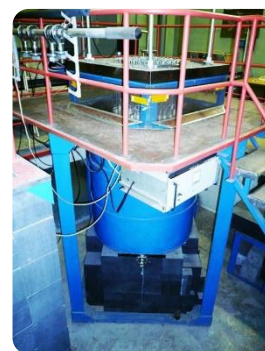
Уран-водная подкритическая сборка
