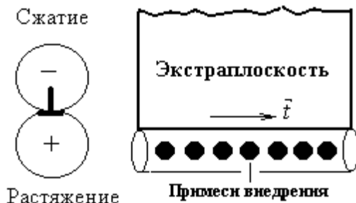
Рис. 3.11. Атмосферы Коттрелла на краевой дислокации
