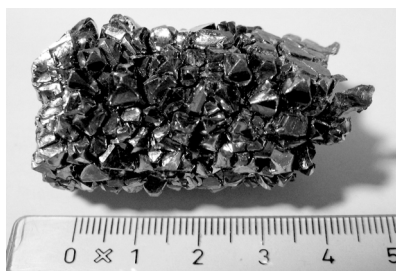
Рис. 2.8. Внешний вид кристаллов иодидного циркония
