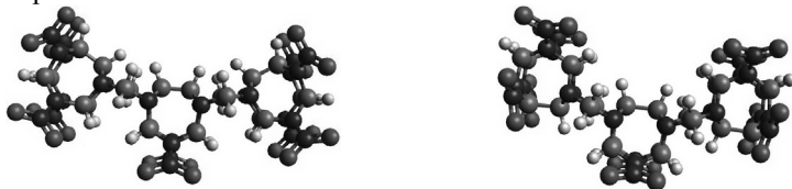
Рис. 1. Тримеры, построенные на основе молекул CL-20, связанные посредством \text{CH}_2 функциональных групп: прямой (слева) и инвертированный (справа)
