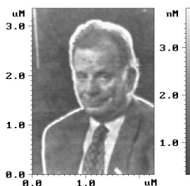
Рис. 1. АСМ изображение поверхности Ti после зондового окисления
