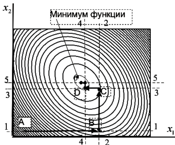
Рис. 4.18. Поиск минимума двумерной функции методом покоординатного спуска
