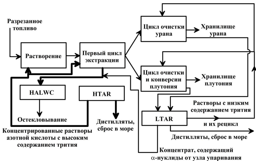
Рис. 8.1. Схема обращения с кислотными потоками на заводе UP3 HALWC (англ. High Activity Liquid Concentration Unit ), узел упаривания рафината первого цикла экстракции; LTAR (англ. Low Tritiated Acid Recovery Unit ), узел упаривания растворов кислоты с низким содержанием трития; HTAR (англ. High Tritiated Acid Recovery Unit ), узел регенерации растворов кислоты с высоким содержанием трития
