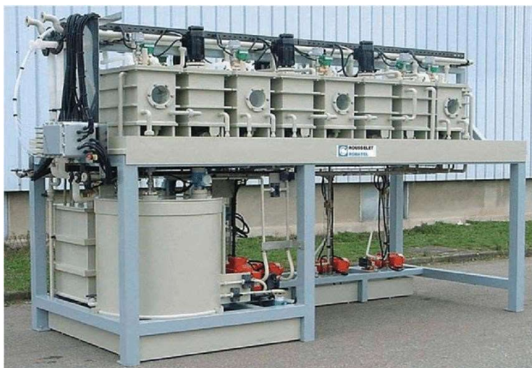
Рис. 6.17. Внешний вид блока смесительно-отстойных реакторов
