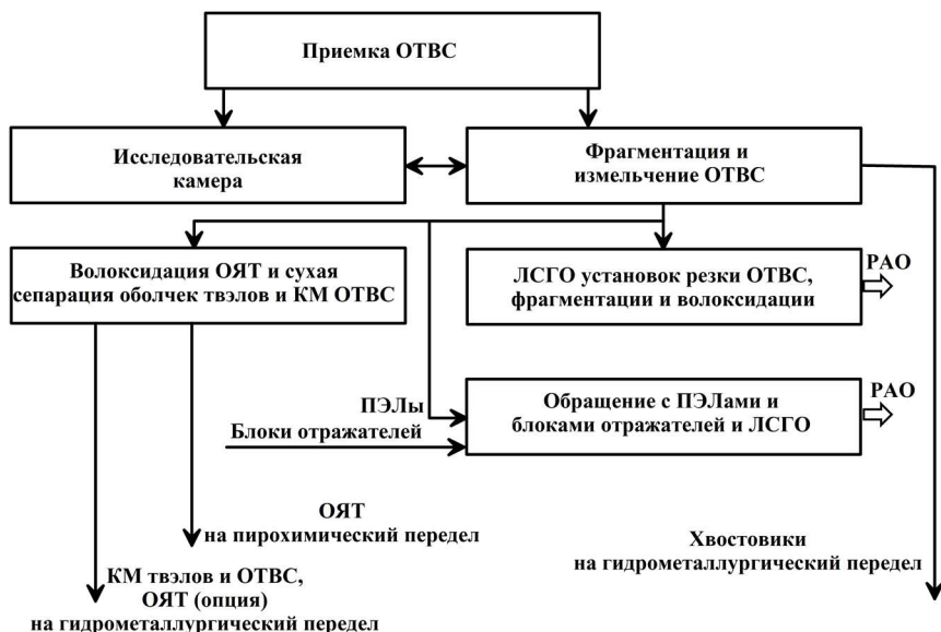
Рис. 7.5. Общая схема переработки СНУП ОЯТ на ОДЭК. Головные операции
