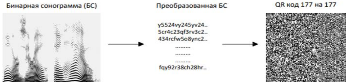
Рисунок 9 – Пример встраивания бинарного маркера в QR-код
