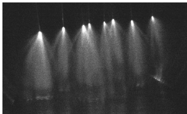
Рис.30. Внешний вид диффузного разряда с многоострийным катодом
