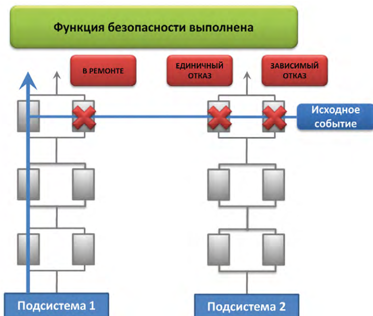
Рис. № 10.19. Двухканальная система безопасности с резервированием 2·100 % и резервированием внутри каналов 2·100 % (пример – система аварийного и планового расхолаживания JNA)
