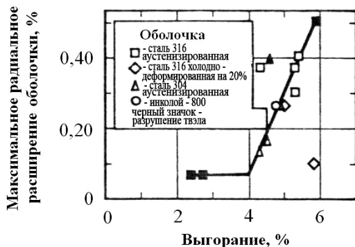
Рис. 6.8. Максимальное увеличение диаметра оболочки \Delta D/D твэла с Na-подслоем в зависимости от выгорания
