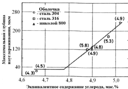
Рис. 5.1. Максимальная глубина выгорания науглероживания различных аустенитных сталей во время облучения смешанных уран-плутониевых карбидов с Na-подслоем в зависимости от эквивалентного содержания углерода в топливе (в скобках указано выгорание в ат. %)
