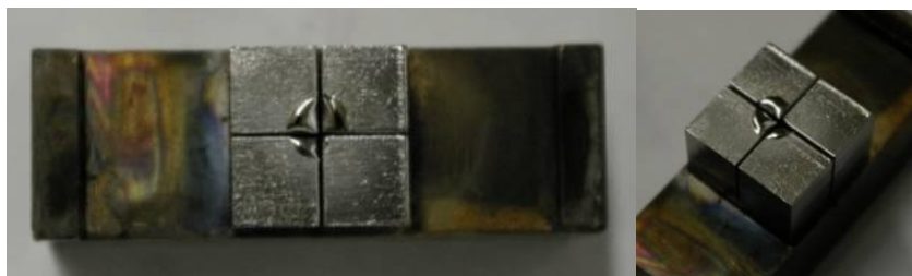
Рис. 2 Внешний вид вольфрамового образца после термоциклирования
