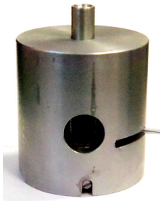
Рис. 5.13. Внешний вид модернизированной оснастки для проведения механических испытаний дисковых образцов современных консолидированных вдавливанием индентора (наконечник индентора в виде шарика WC диаметром 3 мм) в центр образца-таблетки с использованием информационно-измерительной системы ИИС-МЭФС
