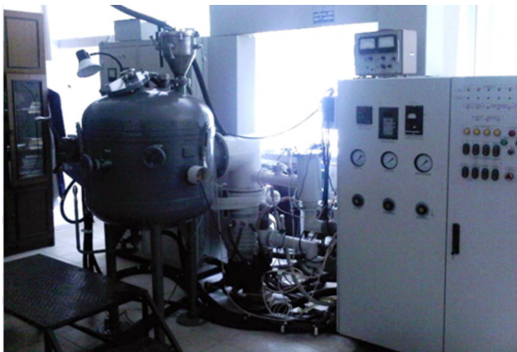
Рис. 1.6. Внешний вид индукционной плавильной вакуумной установки УИПВ-63-10-0,01
