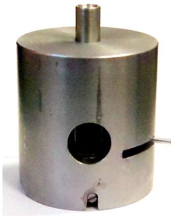
Рис. 4.11. Внешний вид модернизированной оснастки для проведения механических испытаний дисковых образцов вдавливанием индентора (наконечник индентора в виде шарика WC диаметром 3 мм) в центр образца-таблетки с использованием ИИС-МЭФС
