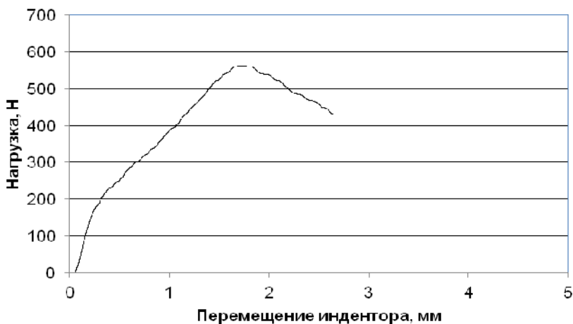
Рис. 4.6. Кривая нагружения консолидированного дискового образца быстрозакаленного порошка меди (мелкая фракция), полученная методом вдавливания индентора на установке ИИС-МЭФС с использованием специально разработанной оснастки
