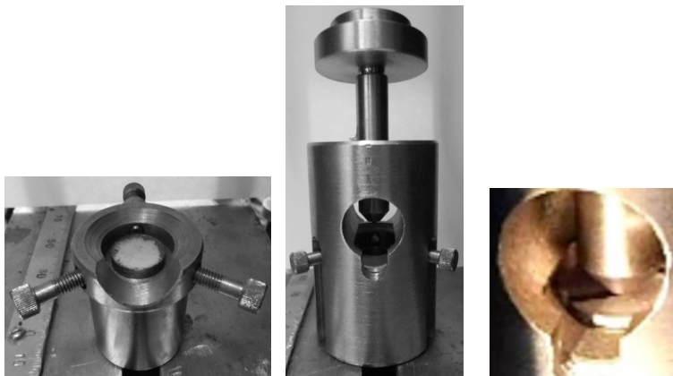
Рис. 4.10. Внешний вид оснастки для проведения механических испытаний дисковых образцов вдавливанием индентора (наконечник индентора в виде шарика диаметром 3 мм) в центр образца-таблетки с использованием ИИС-МЭФС
