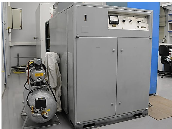
Рис. 5.15. Установка магнитно-импульсной обработки материалов «Импульс БМ»
