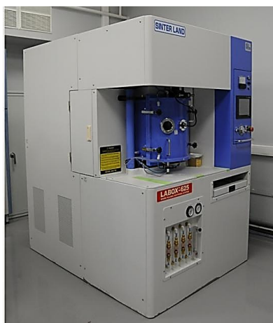
Рис. 5.14. Установка Spark Plasma Sintering System модель Labox-625 от компании Sinter Land Inc
