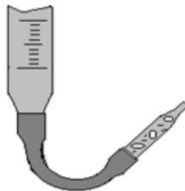
Рис. 4.5. Вытеснение раствором пузырьков воздуха из носика бюретки
