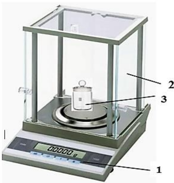
Рис. 4.2. Аналитические весы. 1- сенсорный дисплей с кнопками управления, 2- боковая дверца, 3- бюкс для взятия навески.
