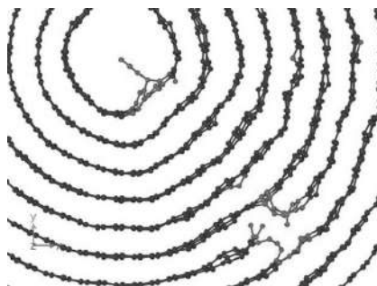
Рис. 3. Моделирование дефектообразования в МУНТ при помощи LAMMPS.
