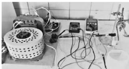
Рис.1 Общий вид лабораторной установки электроплазменной полировки.
