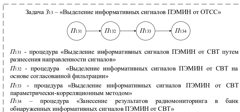
Рис. 8. Представление задачи Z 13 – «Выделение информативных сигналов ПЭМИН от ОТСС» в виде графа состояний
