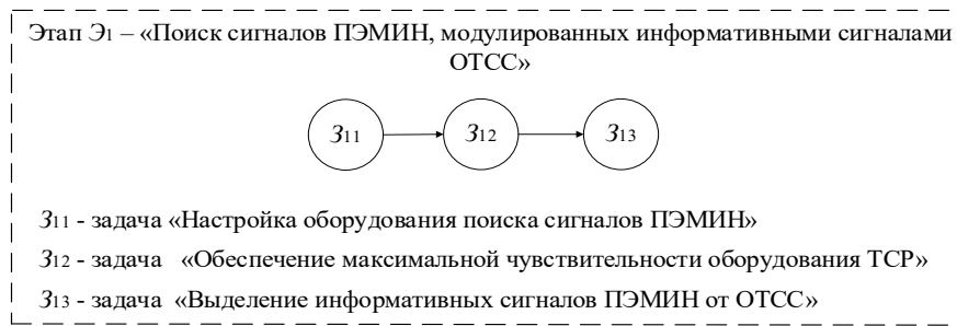
Рис. 5. Представление этапа Э 1 – «Поиск сигналов ПЭМИН, модулированных информативными сигналами ОТСС» в виде графа состояний
