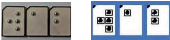
Рис. 2. Слева: плитки Брайля. Справа: результат обработки (найденные точки обведены прямоугольниками).
