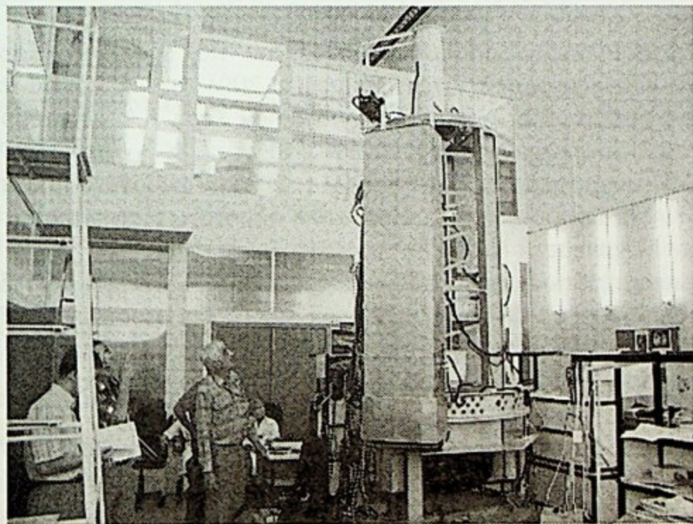
Подготовка технологических образцов научной аппаратуры проекта «Коронас-Фотон» для комплексных испытаний
