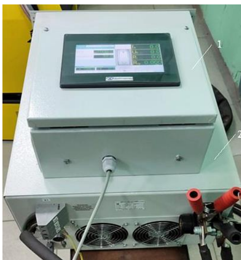
Рисунок 1 – Инверторный источник питания ИОН 48-900: 1 – дистанционный пульт; 2 – силовой блок
