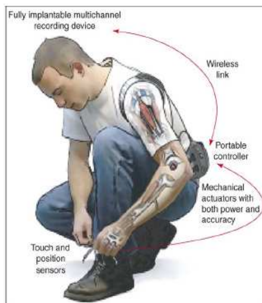
Рис. 6. Перспектива использования ИМК, когда будет обеспечена возможность оперирования протезом как собственной рукой. В этом ИМК как матрицы электродов, регистрирующих активность мозга, так и стимулирующих мозг электродов полностью вживлены в тело человека. Мозг снабжается не только зрительной, но и тактильной и проприоцептивной информацией о состоянии протеза (из [52]).
