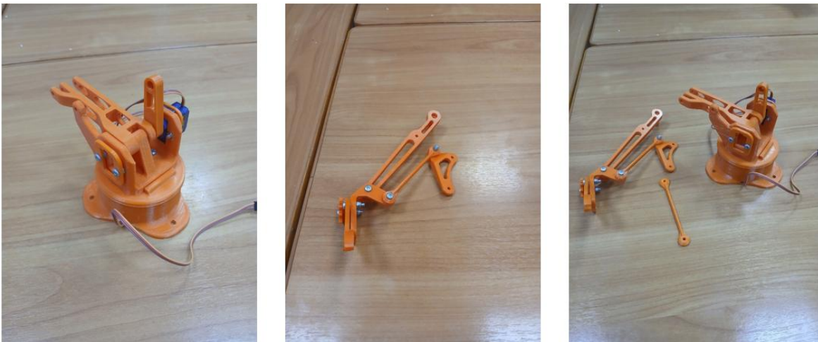
Рисунок 3 – Процесс сборки манипулятора
